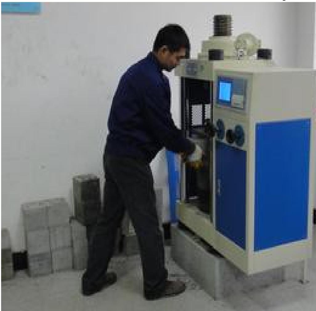
混凝土试件室内抗压
