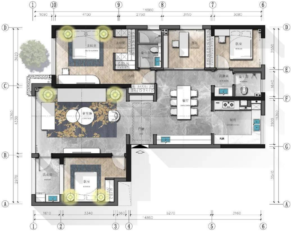
图 1：传统的居住建筑空间设计，注重空间之间的平面组合、面积指标及流线组织，重视各房间的采光通风等因素，但忽视了对空间中人的关注，未针对各种使用人群对空间的特殊需求。如本案例中，优点是空间方正，各房间之间联系合理。但并未考虑老年人的生理特点，洗浴空间等出入口狭小，细节上也没有设置各类无障碍措施等。
