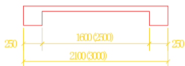
图 10.7.5 相似构件尺寸标注方法
