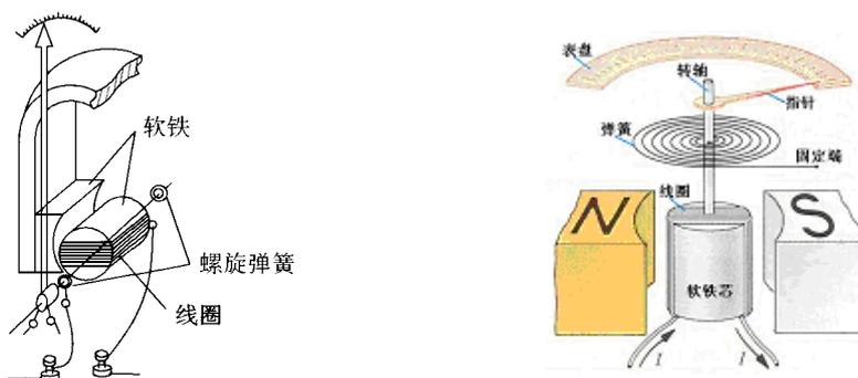
图 3—5 磁电式电表结构原理图
