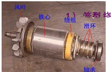
图 4-33 绕线型三相异步电动机转子
